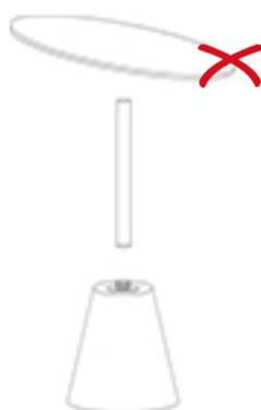
**Столешницу не следует устанавливать в наклонном положении, она должна быть установлена горизонтально**
